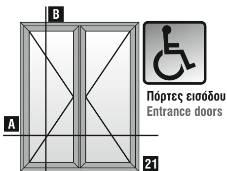
Δίφυλλη πόρτα εισόδου ανοιγόμενη μέσα Double side-hung opening inward entrance door
